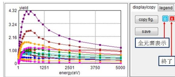
[legend]タブをクリックすると、グラフの各線の凡例が表示される。青い[D]ボタンをクリックすると全ての元素の係数が再表示される。[copy fig.]ボタンをクリックすると表示画面を<jpg>形式で保存できる。[save]ボタンをクリックすると二次電子放出係数のデータを<csv>形式で保存できる。[default]ボタンの横にある赤い[X]ボタンをクリックするとデータベースが終了する。
