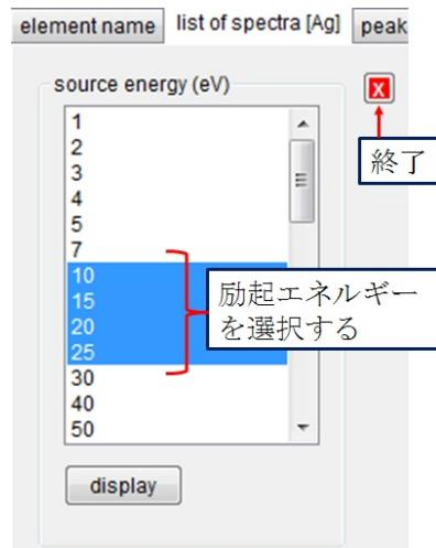
リスト上で励起エネルギーをマウスでクリックするか、あるいは[shift]キーを押しながらマウスでドラッグして[display]ボタンをクリックするとスペクトルが表示できる。Ag を 2000V で励起したときに得られる AES スペクトルを下に示す。縦軸は[current(pA)]で示される。ISO14976 では電流値は nA で示す事になっているが、後藤先生の測定値は pA で表されているので、COMPROMO では pA で示してある。
