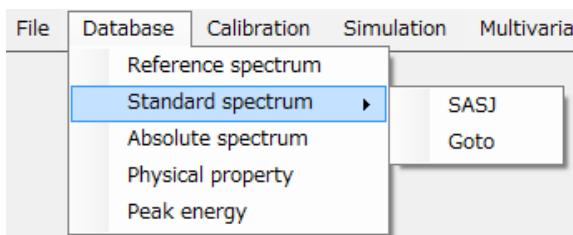
[Standard spectrum]をクリックすると[SASJ]と[Goto]を選択するサブメニューが現れる。[SASJ]をクリックすると double pass 分光器を使用して取得した Au と Cu の XPS スペクトルと、後藤先生が作製された標準分光器を用いて取得した Au, Ag と Cu の AES スペクトルのリストが現れる。
