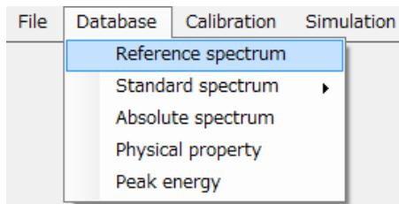
[Reference spectrum]をクリックすると、スクリーンの右側に元素テーブルが現れる。元素テーブルから元素名を選択してクリックすると、その元素を含むスペクトルのリストが表示される。
