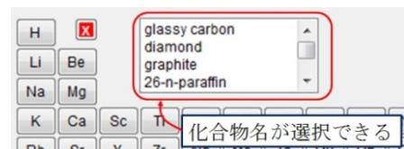
化合物名はリスト内に記述されている。赤い[X]ボタンをクリックするとデータベースが終了する。元素テーブルのボタン、あるいはリスト内の化合物名をクリックすると選択した元素あるいは化合物の物理定数が表示される。IMFP は TPP-2M 式を用いて計算される。
